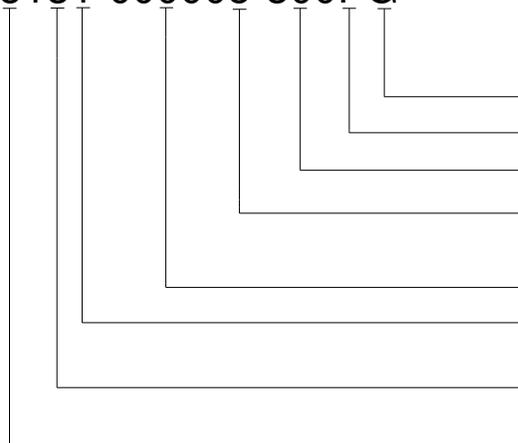
压力类型 (G=表压, A=绝压, S=密封表压)
