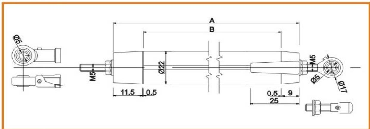
**应用范围：** KPM是微型绞接式结构，适合于较小机械行程且有摆动的位置检测，对安装的對中性無任何要求。如：机器人、取出機、磚機、陶瓷機械、水閘等。
