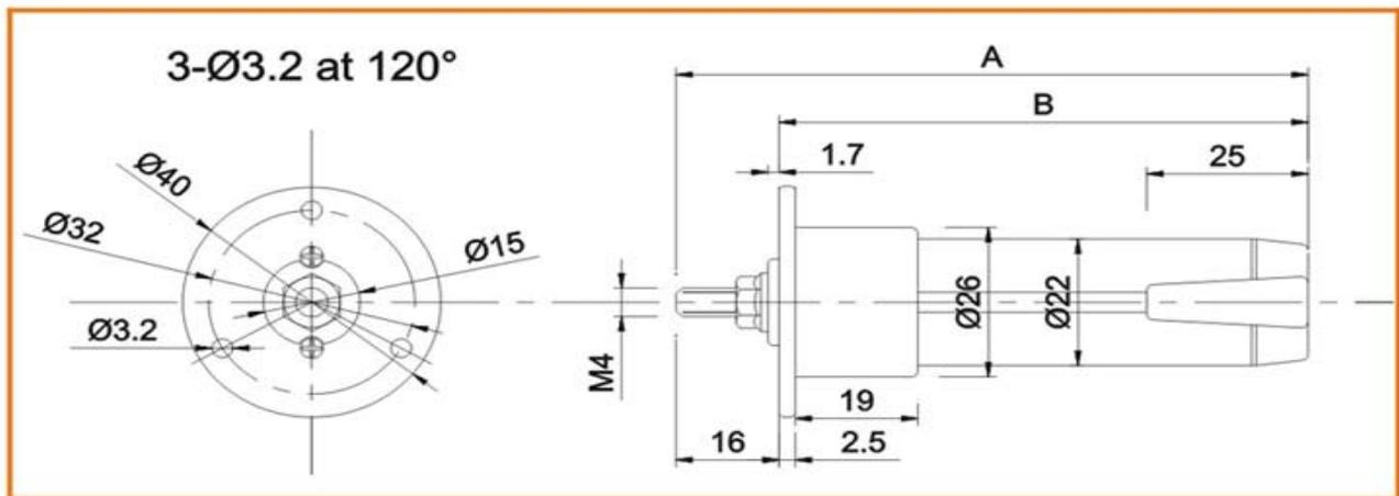
**应用范围:** KPF是微型拉杆式的法蘭面安裝結構，適合設備腔體內部檢測的應用場合。如：煤炭機械、液壓機械、腔體內部位置檢測等。
